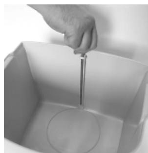
Работа устройства без электрода будет невозможна, так как он является элементом блокировки.
