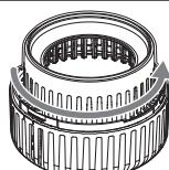
Закройте корпус фильтра, повернув против часовой стрелки.
